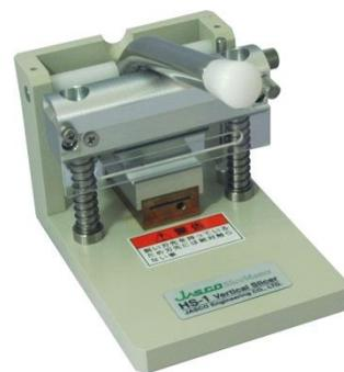
① サンプルホルダーに小さくカットしたサンプルをセット、更にサンプルホルダーをステージに差し込む。
