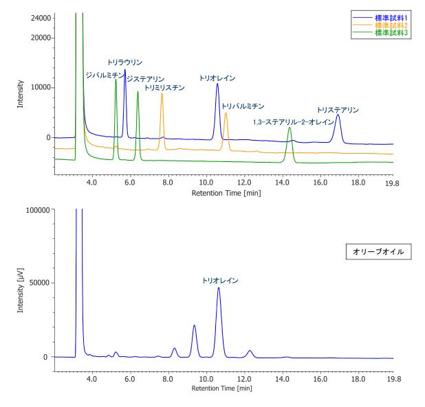
Keyword:油脂,トリグリセライド,トリアシルグリセロール,トリグリセリド,オリーブオイル,トリラウリン,トリオレイン,トリステアリン,トリミリスチン,トリパルミチン,ジパルミチン,ジステアリン, Wrapsil C18, C18カラム, RI検出器
